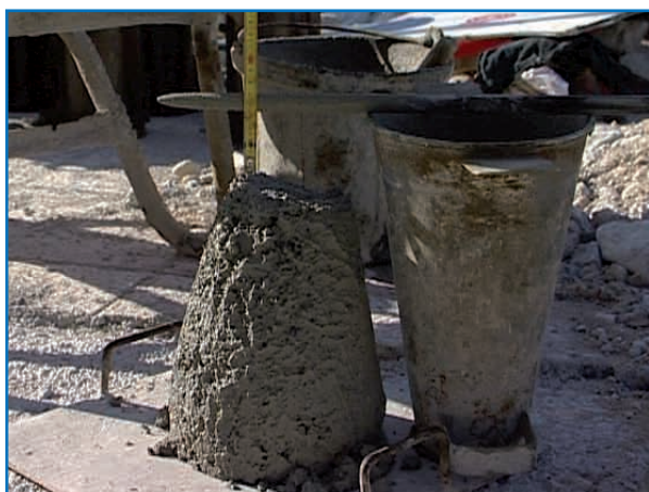
Ensayo consistencia, mediante el cono de Abrams.
