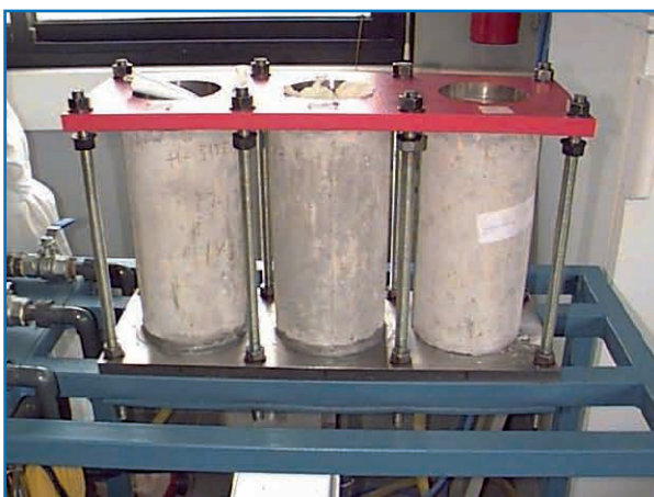
Determinación de la profundidad de penetración de agua bajo presión.
