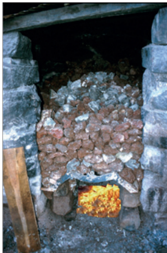
Foto 9. Hornos tradicionales en los que la empresa Yesos y Minas de Albarracín fabrica sus morteros de yeso, disponibles en distribución comercial
