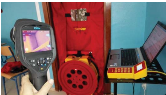
Foto 2. Equipos Blower Door y Cámara Termográfica
