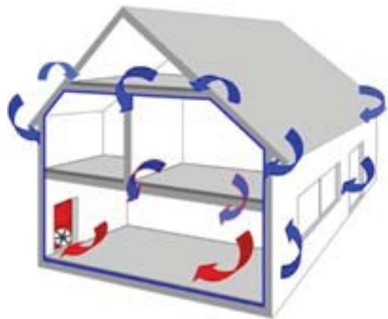
Imagen 3. Circulación del aire durante la prueba de estanqueidad Blower Door
