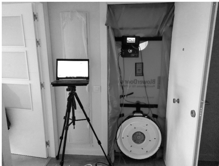
Figura 1. Equipo de Puerta soplante para la ejecución del ensayo de hermeticidad al aire
