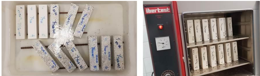
Figura 5. Probetas prismáticas durante el ciclo de agua (izquierda) y durante el ciclo de secado (derecha) – Serie IV
