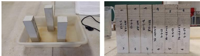
Figura 3. (Izquierda) probetas prismáticas durante el ensayo de absorción por capilaridad. (Derecha) medición del nivel de agua alcanzado - Serie II
