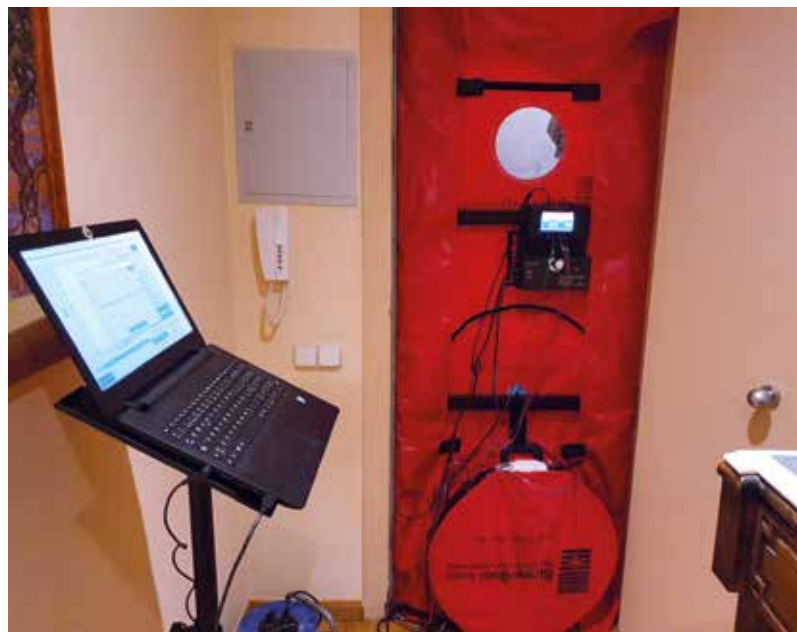
Ubicació del ventilador durant el test.
