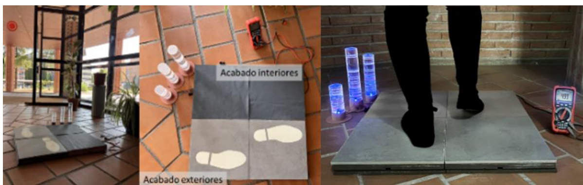
Figura 2. Montaje de demostrador del sistema de pavimento generador de energía
