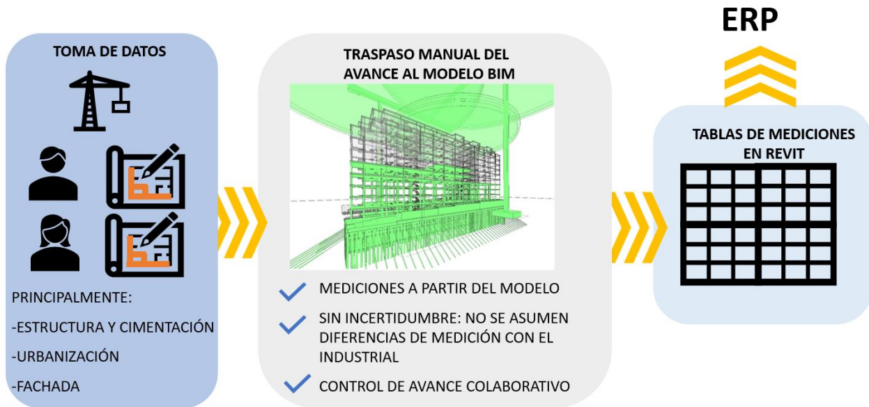
Figura 2. Control de avance de exteriores y estructura
