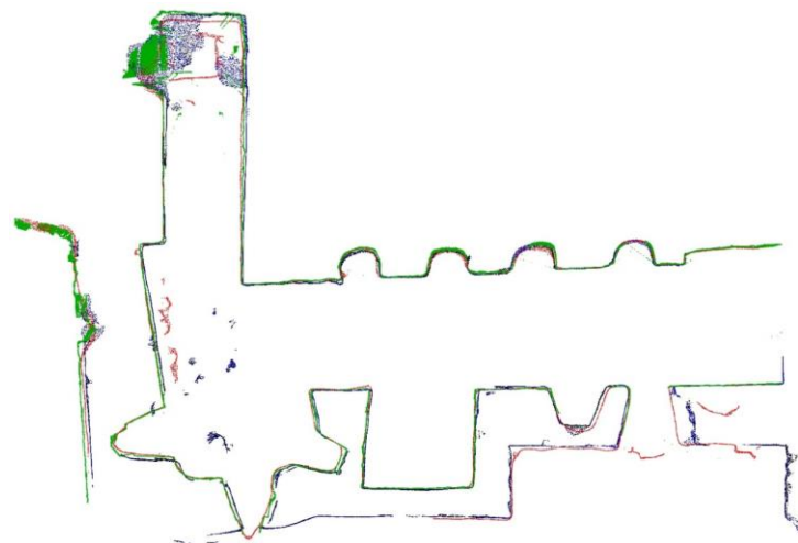
Figura 4. Comparación de métodos de captura sobre el escenario B (sala artillera del castillo de Moya) con el software CloudCompare. Leyenda: Verde, TLS; rojo, LiDAR de iPad Pro; azul, cámara 360.
