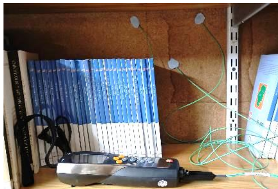
Figura 2. Colocación del aparato y los sensores de temperatura interiores.
