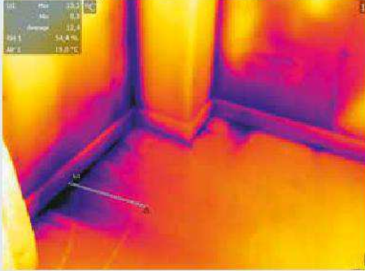
Imágenes tomadas durante un ensayo de estanqueidad en una vivienda
