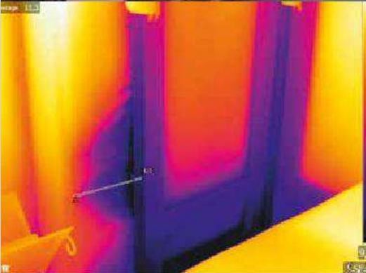
Detalle de las importantes infiltraciones de aire exterior del mirador
