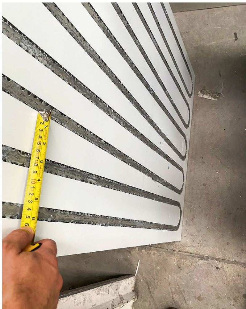
Parte posterior del panel de alta eficiencia Sunthal Dress, donde se aprecia el serpentín patentado.
