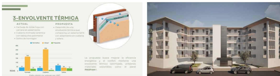
Figura 4. Análisis de la envolvente térmica. Infografía del edificio forrado con el SATE
