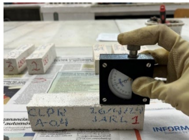
Figura 1. Determinación de la dureza por medio de durómetro Shore D.
