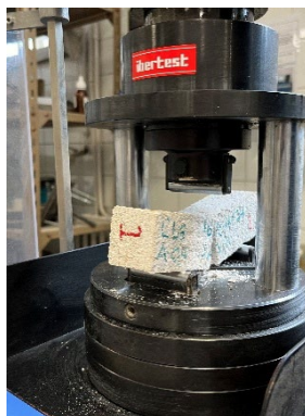
Figura 2. Ensayo de resistencia a flexión mediante equipo Autotest de Ibertest.
