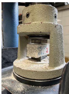
Figura 3. Ensayo de resistencia a compresión mediante equipo Autotest de Ibertest.
