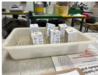
Figura 6. Ensayo para determinar el coeficiente de absorción de agua.
