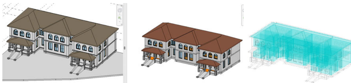
Figura 24. (izq) Modelo nativo HBIM, (centro) Modelo optimizado para simulación (der) Modelo analítico extraído del modelo optimizado del Colegio General navarro. Fuente: Propia
