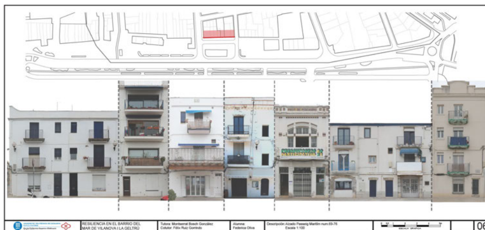
Figura 3. Alzado Passeig Marítim num. 69-76 montaje mediante imágenes rectificadas de cada fachada. Fuente: Oliva, 2022
