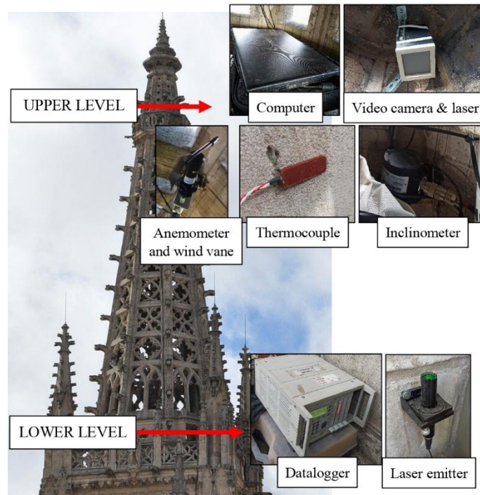
Figura 5. Esquema general de los sensores y dispositivos instalados en la aguja.
