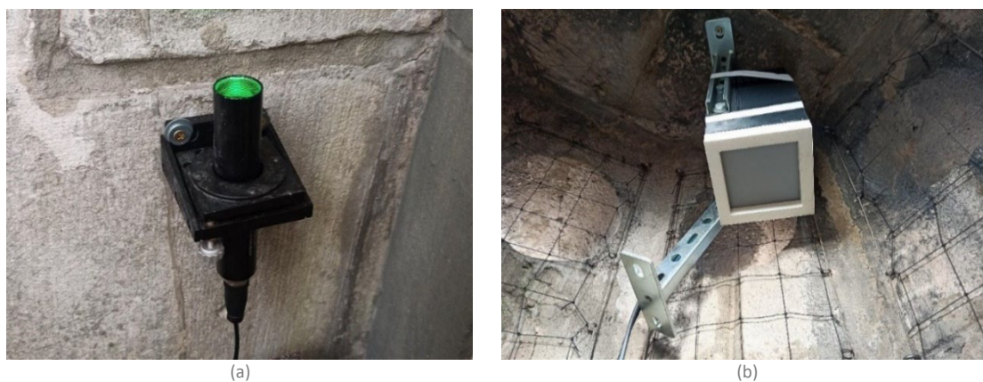
Figura 2. Sistema LVBDT: (a) Emisor láser, (b) caja que contiene la cámara y el panel traslúcido.
