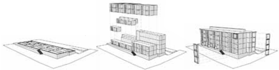
SEQÜÈNCIA DE MUNTATGE DE L'EDIFICI DE TORELLÓ, QUE ÉS VÀLIDA, AMB PETITES VARIANTS, PER A TOTS ELS SISTEMES PRESENTATS A LA JORNADA
