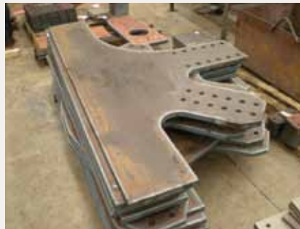
PECES PENDENTS D'ACOBLAR PER A CONFORMAR UN PILAR. ES TRACTA DELS NUSOS DE LA PART SUPERIOR DELS VOLADISSOS, JA QUE EN UNA CARA NO TENEN ENTRONCAMENT
