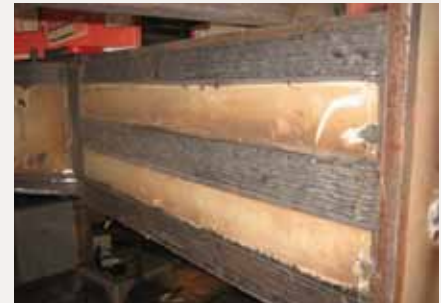
S'OBSERVA LA PEÇA ACABADA AMB LA QUANTITAT DE CORDONS EN SUPERFÍCIE QUE QUEDEN EN EL PUNT MÉS OBERT DEL BISELL
